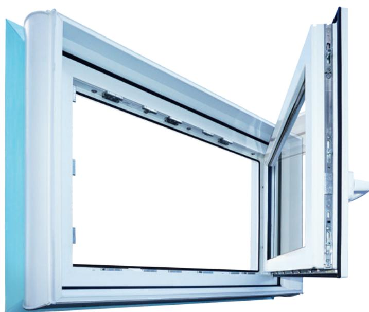
Schließteile, Verriegelungzapfen und bei den Führungsschlitzen die darunterliegende Riegelstange mit Staufferfett oder technischer Vaseline fetten.
